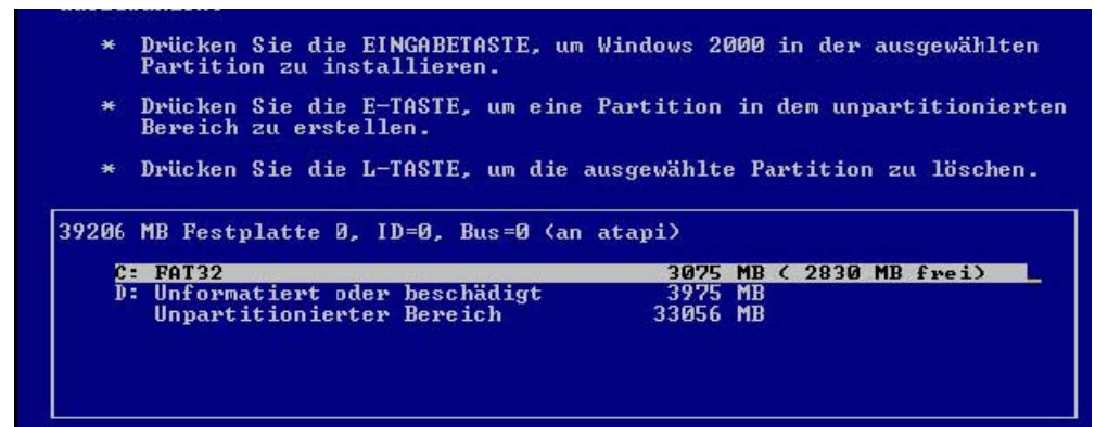
Abbildung 2.12. Windows 2000 Pro Setup: Übernahme der Partitionierung
