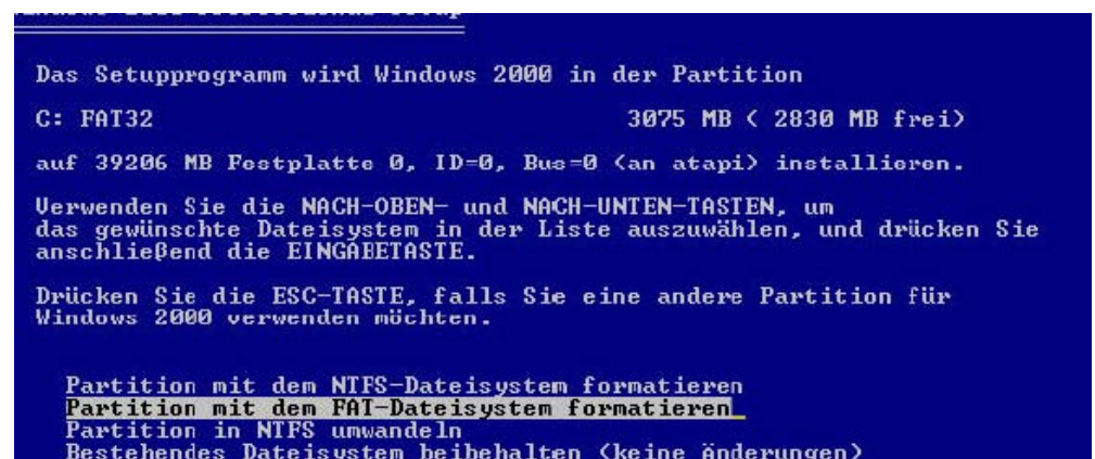
Abbildung 2.13. Windows 2000 Pro Setup: Formatierung der Partition
